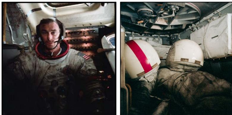
**FIGURE 4.2.1.4.1-1: DUST CONTAMINATION DURING APOLLO 17**
