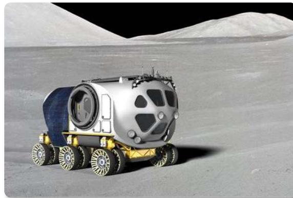
**FIGURE 4.6.2-1: PRESSURIZED ROVER CONCEPT**
